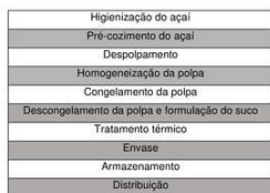
Figura 1. Fluxograma do processo de produção do suco de açaí (forma líquida)
