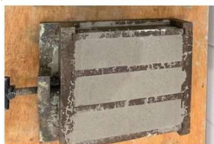
– Molde metálico utilizado na fabricação dos compostos com argamassa com adição da fibra.
