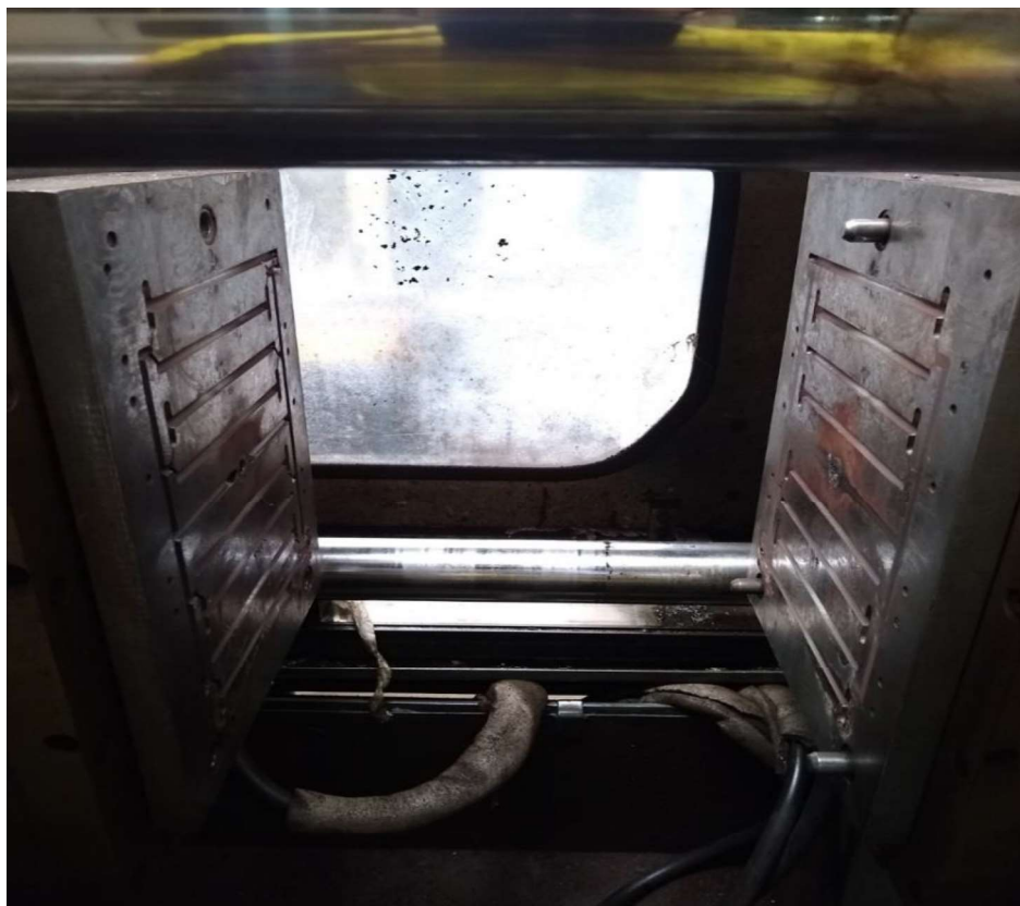
Foto 10 – Máquina Injetora para solado bicolor
