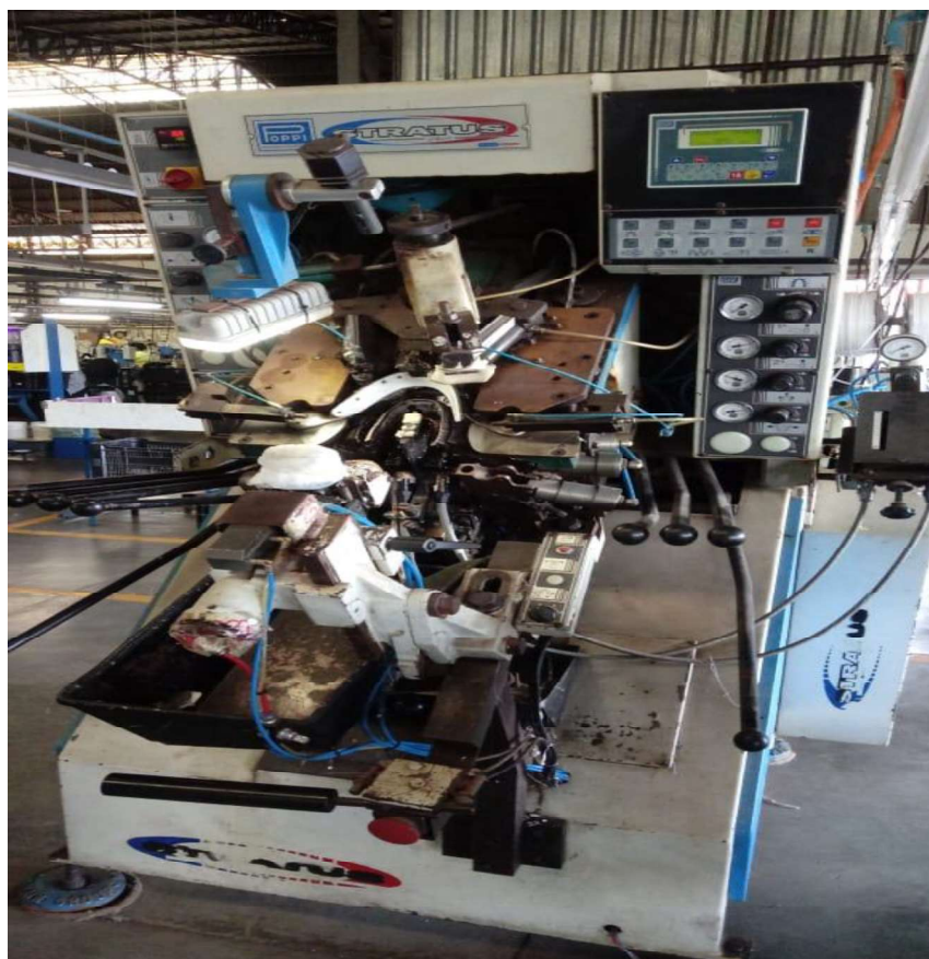
Foto 13 – Máquina de Montar o bico do calçado.
