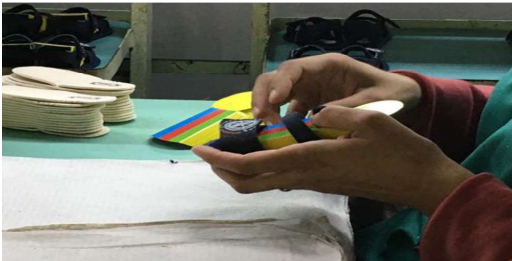
Foto 16 – Acabamento do calçado, introduzindo palmilha interna.
