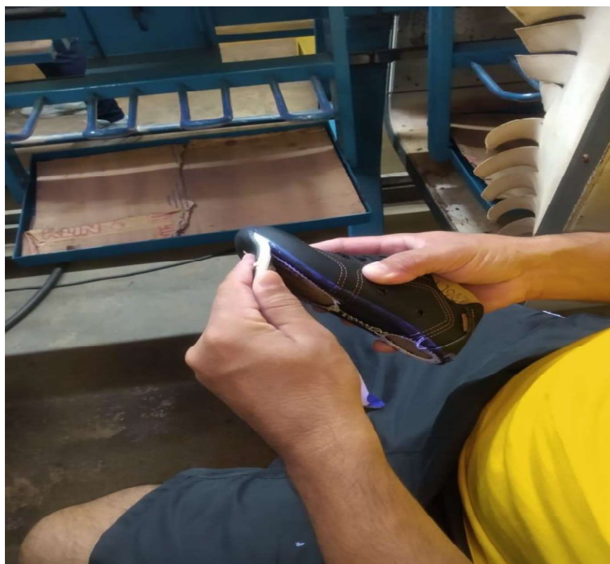
Foto 15 – Operação de unir solado ao cabedal.
