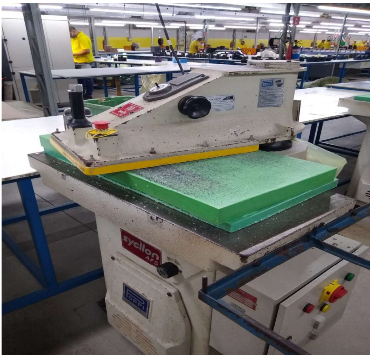
Foto 02 – Balancim (Prensa Hidráulica) para corte de calçados.
