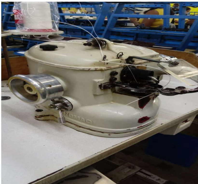
Foto 13 – Máquina de Montar o bico do calçado.
