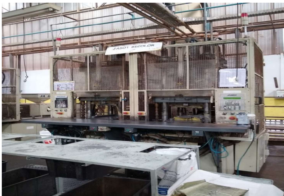
Foto 10 – Máquina Injetora para solado bicolor
