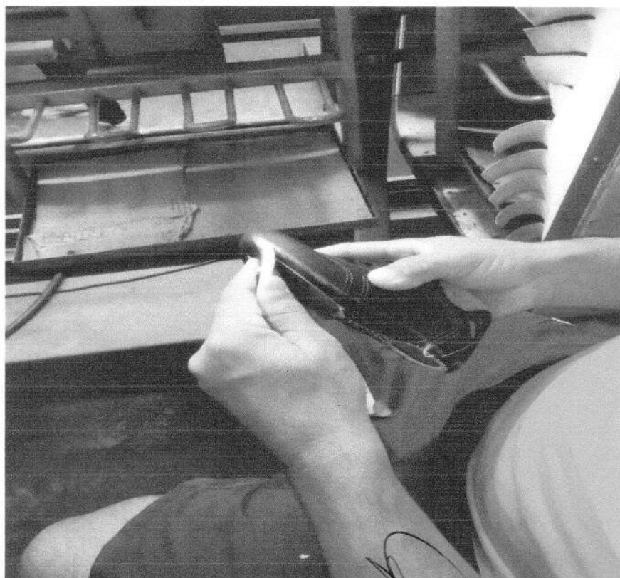
Foto 15 – Operação de unir solado ao cabedal.
