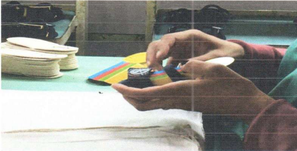
Foto 16 – Acabamento do calçado, introduzindo palmilha interna.
