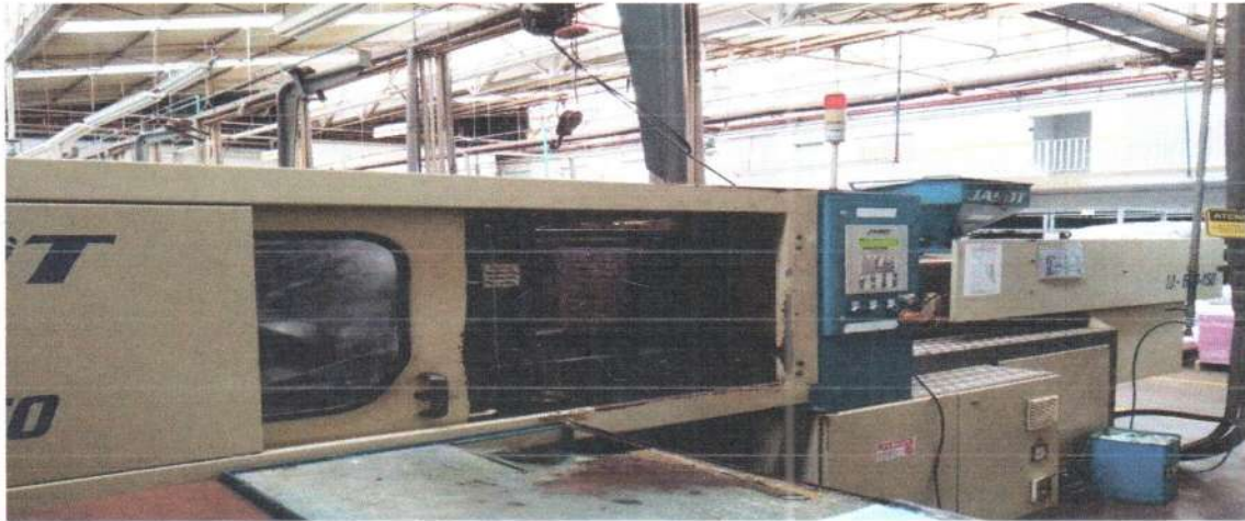
Foto 08 – Máquina Injetora para solado monocolor
