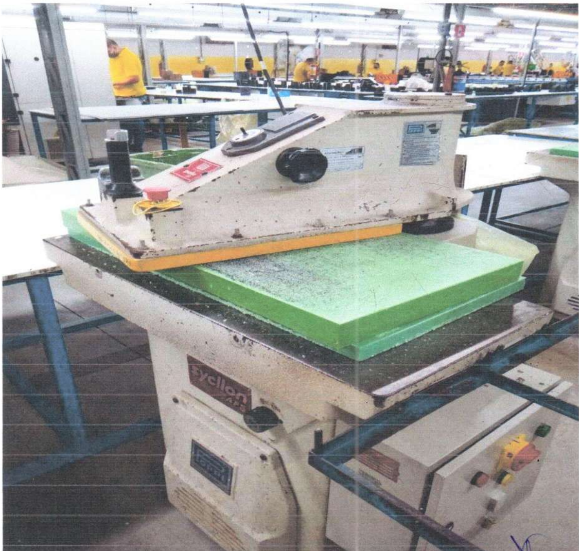
Foto 02 – Balancim (Prensa Hidráulica) para corte de calçados.
