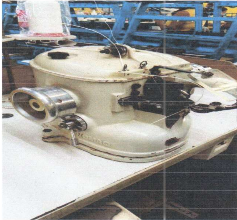
Foto 13 – Máquina de Montar o bico do calçado.
