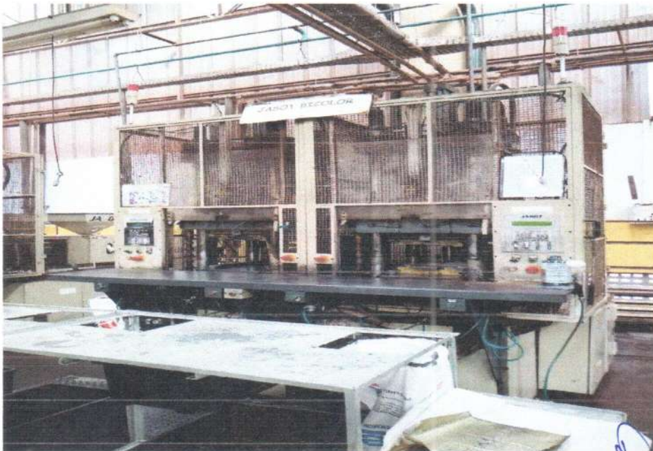
Foto 10 – Máquina Injetora para solado bicolor
