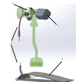
Figura 1: Acionador de Descarga de Mictório por Pedal, com Bóia Envolvente (1), Presilha (2), Pedal Flexível (3) e Cabo (4)
